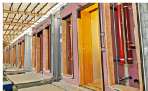
MiC(組裝合成)建築法，組件先在廠房生產。
